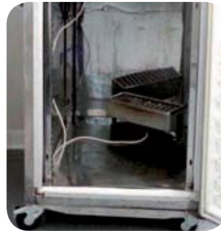
Figure 4 : système de chauffage par résistance
