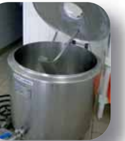
Tank à lait réaménagé en cuve de fabrication
