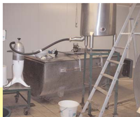
Installation avec utilisation de la gravité
