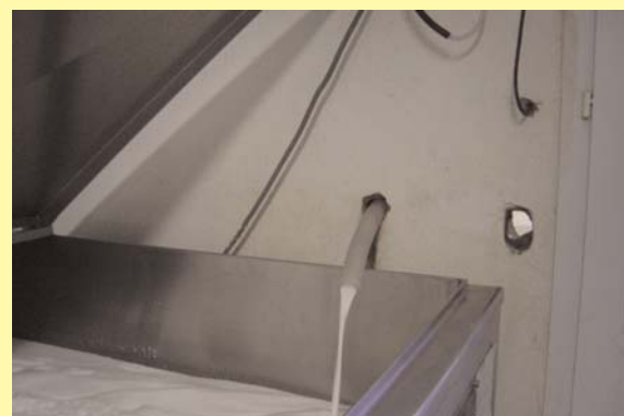
Acheminement du lait écrémé via un tuyau pour passage dans le mur
