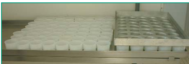
Photo 1 / Moulage au répartiteur sur moules individuels
