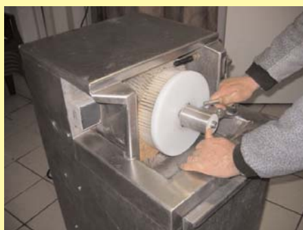
Exemples de machines à frotter rencontrées dans des ateliers des Pyrénées-Atlantiques
