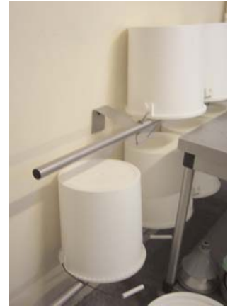
Systèmes de transfert : bac tampon (bac à levier), seaux
